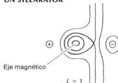
Figura 2 VARIACIONES GEOMETRICAS DE LOS CAMPOS MAGNETICOS DE CONFINAMIENTO EN UN STELARATOR
